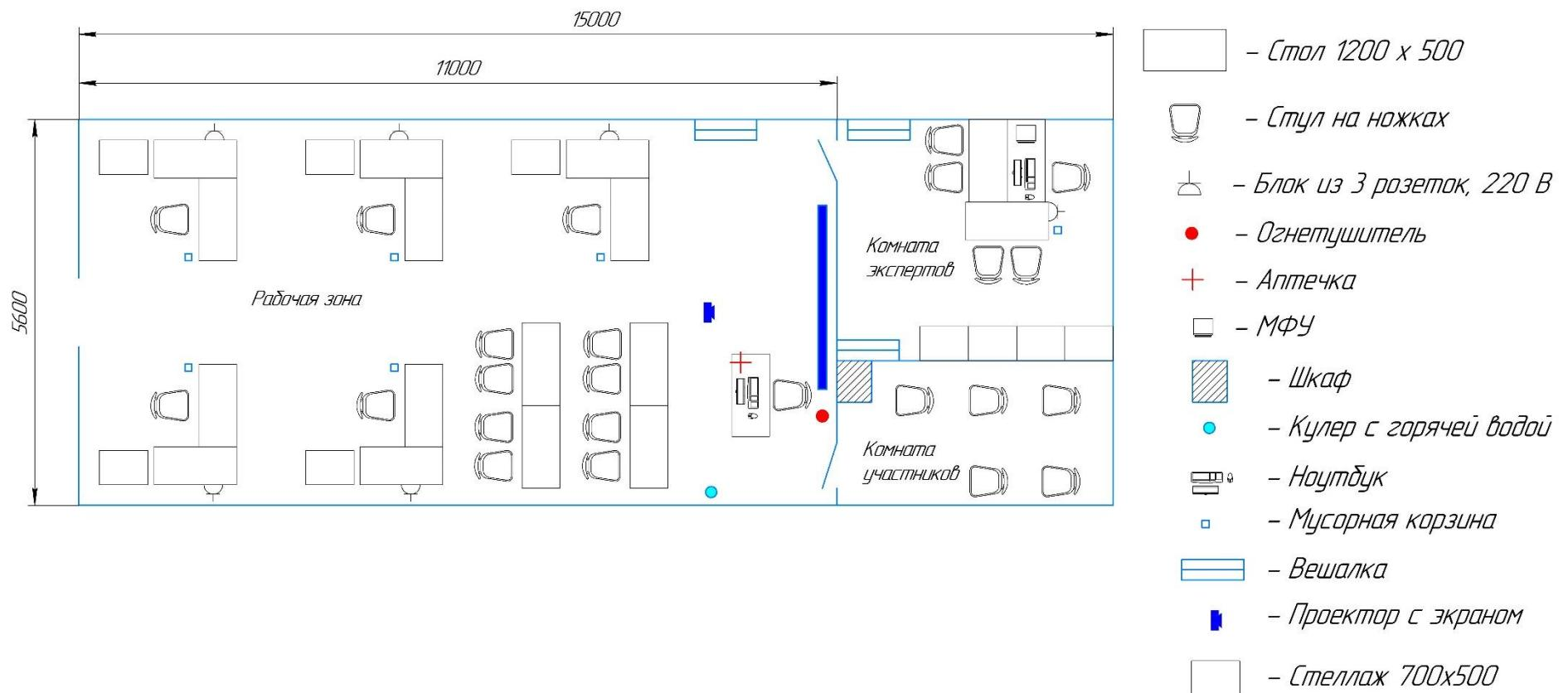
**План застройки компетенции «Сборка-разборка электронного оборудования»**
